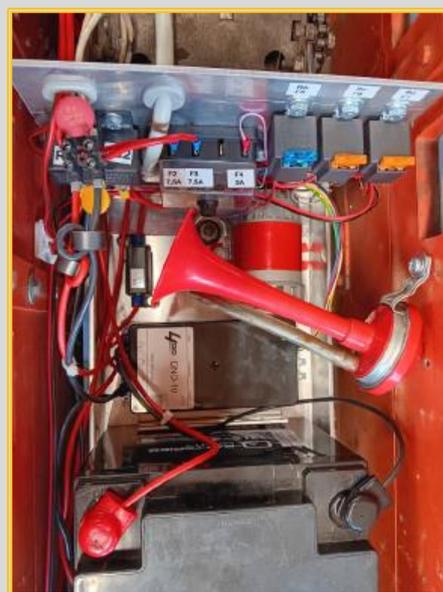
Zuerst erfolgte der Einbau der neuen Blindfenster, dann der neu gefertigten Batteriewanne mit den seitlichen Bauteilaufnahmeplatten. Anschließend wurden die elektrischen Bauteile eingebaut und verdrahtet. Ein Test auf der Anlage von Helmut verlief erfolgreich.
