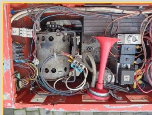
Obige Bilder zeigen die 2095 beim Entkernen nach der Fahrseason 2023. im Herbst und Winter 2023 wurde die neue Elektrik geplant, der Schaltplan erstellt, die entsprechenden Teile bestellt und ein erstes Muster gefertigt. Nach der Säuberung der Lok wurde sie im Januar 2024 zu Helmut Ehrle gebracht, da er angeboten hatte, den Umbau in seiner Werkstatt durchführen zu können.
